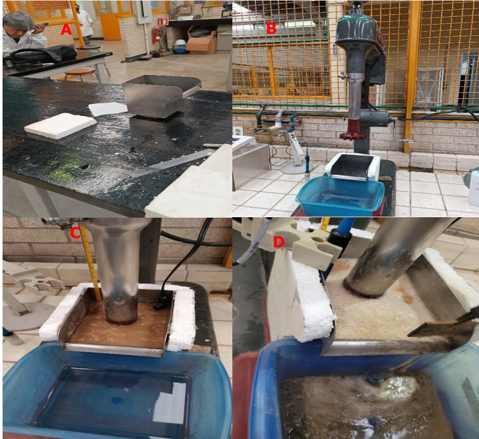
FIGURA 22. SECUENCIA DE FLOTACIÓN CON VARIABLE TEMPERATURA 86°C (A, B, C, D)
