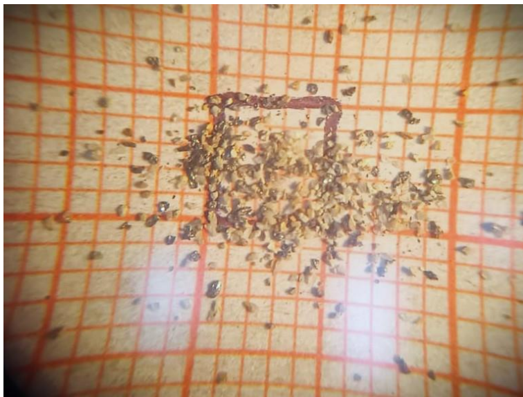
FIGURA38. TAMAÑO DE LIBERACIÓN OBSERVADO DE LA PEGMATITA (MOLIENDA)
