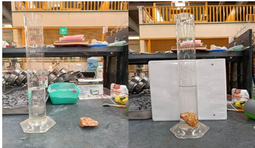
FIGURA 24. DETERMINACIÓN EXPERIMENTAL DE LA DENSIDAD DE LA PEGMATITA
