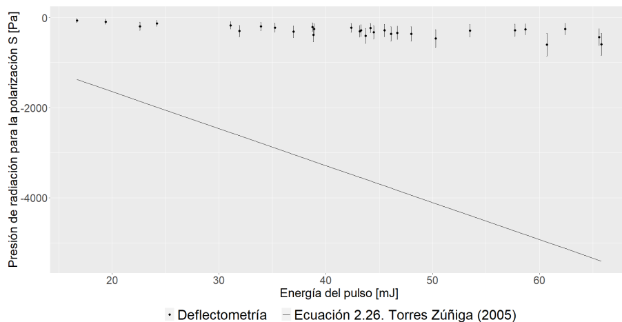
Figura 4.25: Resultados de presión radiométrica a presión atmosférica y con alambres de titanio.
