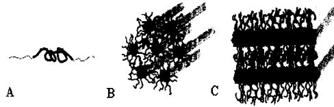
Figura 2.6.2. Estructuras de agregación formadas por copolímeros en solución. A) unímero de copolímero de tres bloques, B) arreglo hexagonal y C) arreglo laminal.
