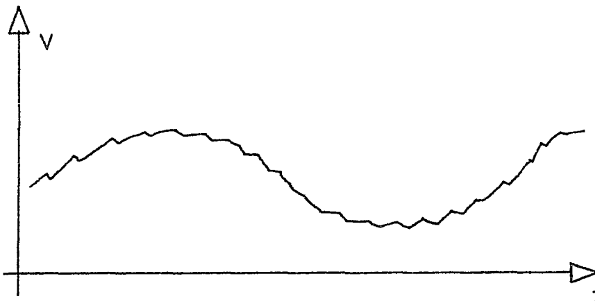
FIG. 2.12 REPRESENTACION DEL VOLTAJE ENTRE LOS EXTREMOS DEL CAPACITOR
