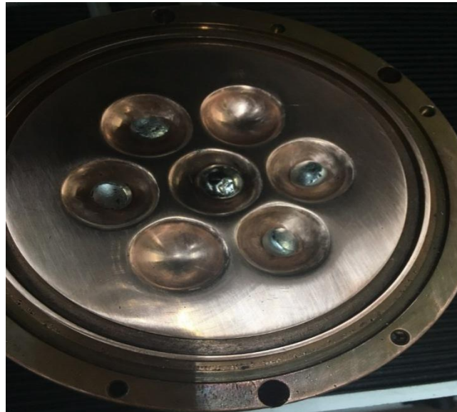
Figura 3.2. Lingotes obtenidos mediante horno de arco eléctrico.
