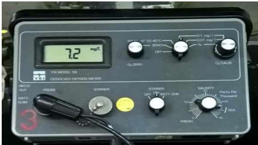
Figura 2-10. Oxímetro YSI modelo 58, utilizado en medición de DBO.
