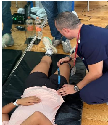
Figura 1. Sensores Trigno IM® (Delsys Inc., EE.UU.) con tecnología de electromiografía de superficie e integración de unidad inercial (IMU).
