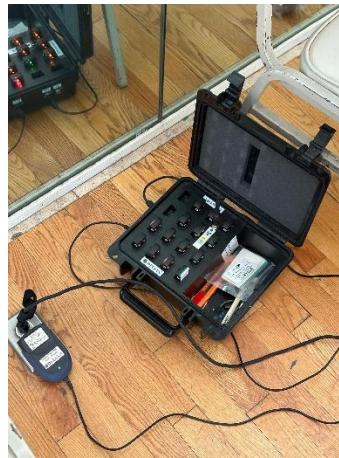
Figura 1. Sensores Trigno IM® (Delsys Inc., EE.UU.) con tecnología de electromiografía de superficie e integración de unidad inercial (IMU).
