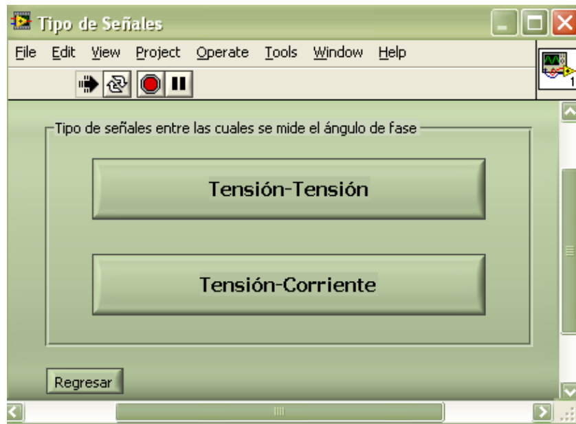
Figura 45. Elección del tipo de señales entre las que se mide el ángulo de fase.
