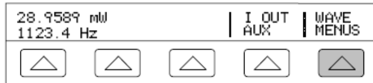
Figura 32. Menú waveform para la calibración de ángulo de fase tensión-corriente.
