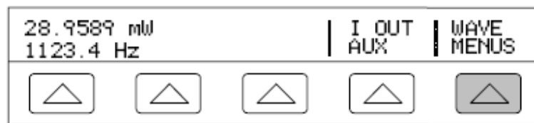
Figura 25. Menú waveform para la calibración de ángulo de fase tensión-tensión.
