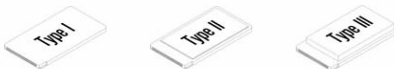
Figura 39. Tarjetas PCMCIA Tipo I, II y III.
