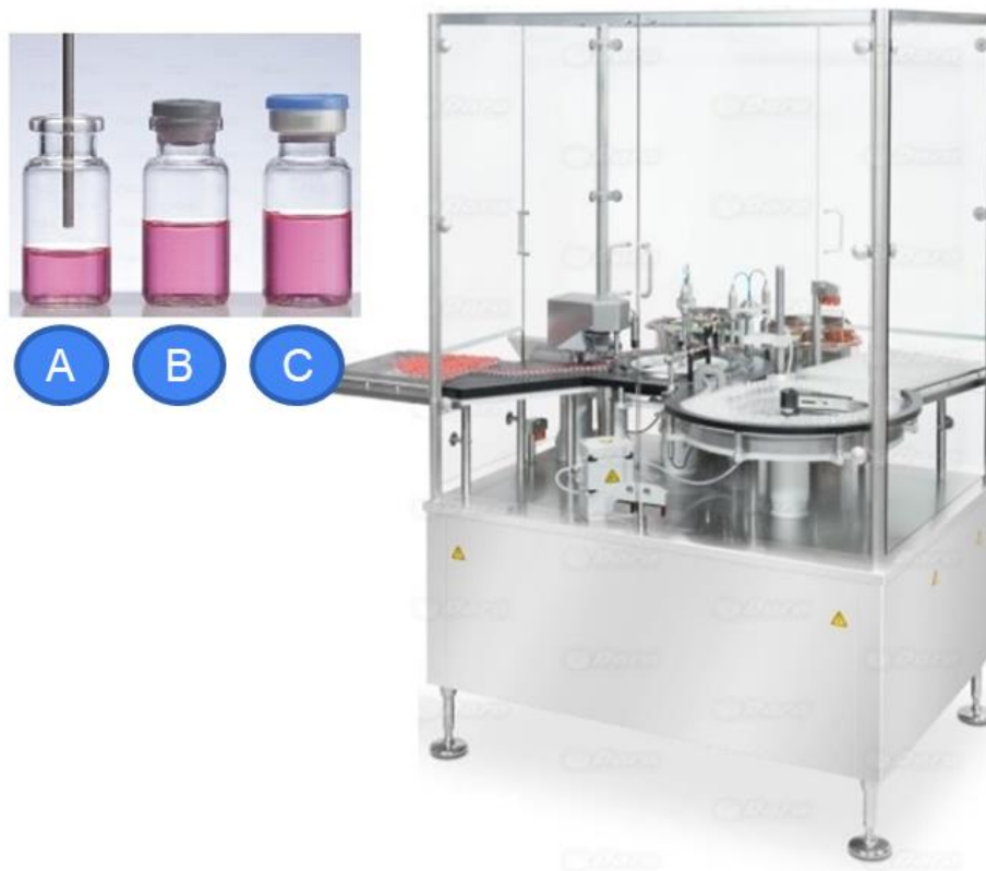
FIGURA 9. MAQUINA LLENADORA Y CERRADORA AUTOMÁTICA DE VIALES. 25 SE OBSERVA A) VIAL CON VOLUMEN, B) VIAL TAPONADO Y C) VIAL CERRADO.
