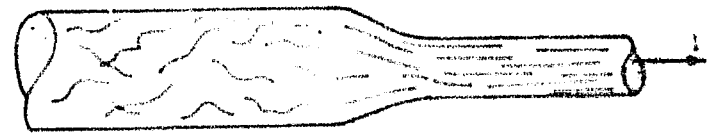
Fibra de Nylon antes del estirado Fibra de Nylon después del estirado
