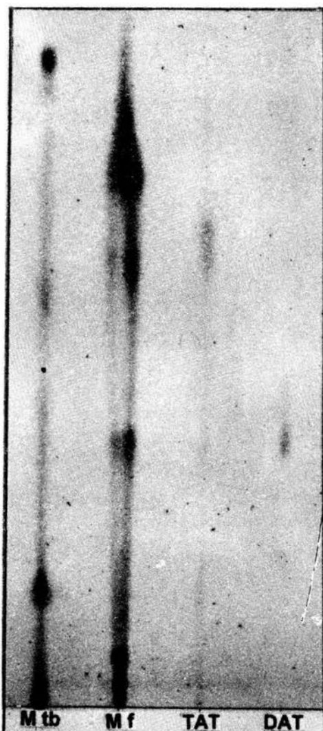
Fig. 3.1 Análisis cromatográfico sobre sílica gel (solvente: \text{CHCl}_3 / \text{CH}_3\text{OH} / \text{H}_2\text{O} 60:16:2, v/v) de los extractos lipídicos de M. tuberculosis (M.tb), M. fortuitum (M.f) y de los glicolípidos triacil-trehalosa (TAT) y diacil-trehalosa (DAT) de M. fortuitum .
