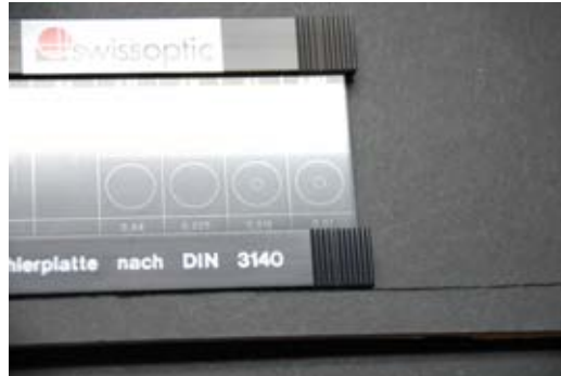
Figura 3.8: Imagen del patrón de rasguño iluminada con luz difusa
