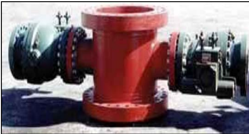
Figura 2-20. Sistema desviador de flujo.
