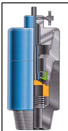
Figura 2-15. Válvula en el piso de perforación.
