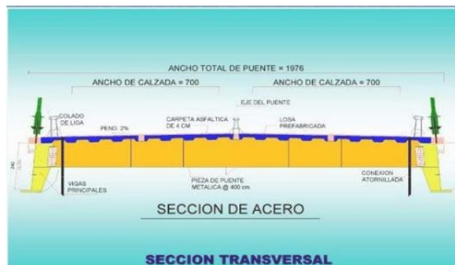
Figura 12.-Sección transversal puente "Papaloapan". (Patrón, 2009)
