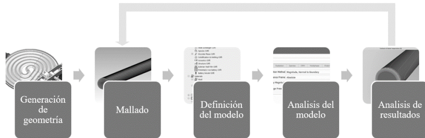
Figura 23. Proceso iterativo para el análisis del sistema mediante ANSYS fluent. Elaboración propia
