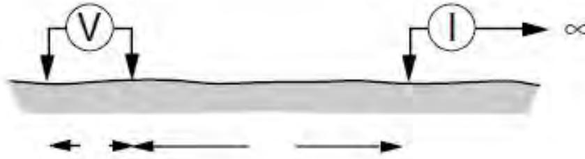
Figura 2.15: Arreglo tipo polo-dipolo. Obtenido de [Milsom \(2003\)](#).
