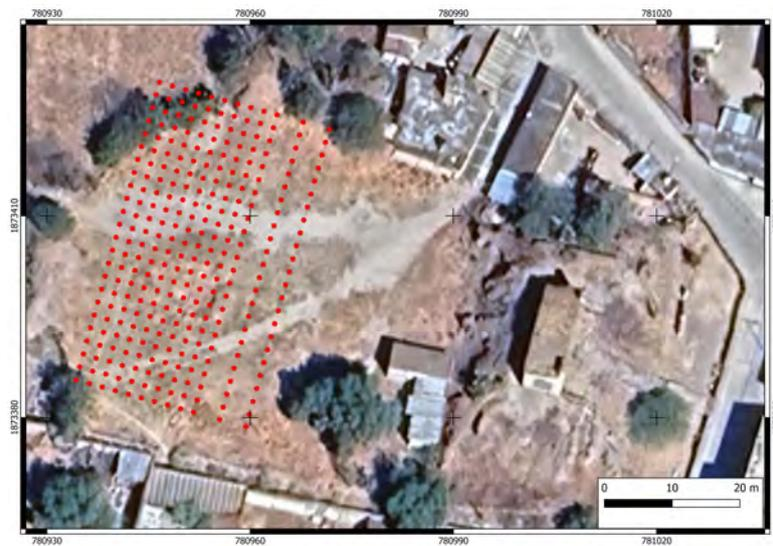
Figura 4.4: Levantamiento magnetométrico en el Grupo del Adobe.
