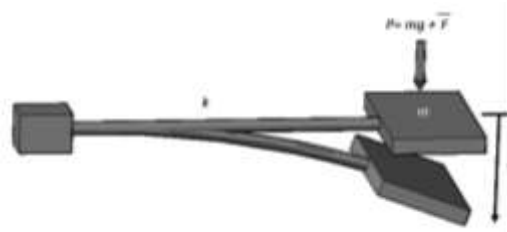
Figura 3.1 Respuesta media de un oscilador de un grado de libertad.
