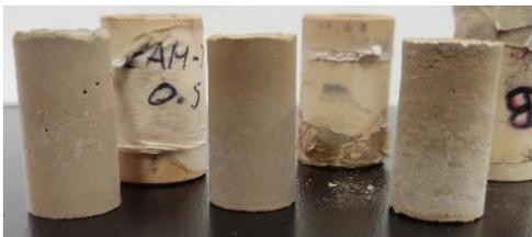
Figura 16. Probetas de GPs de EAH:PP
