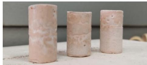
Figura 17. Probetas de GPs de MK
