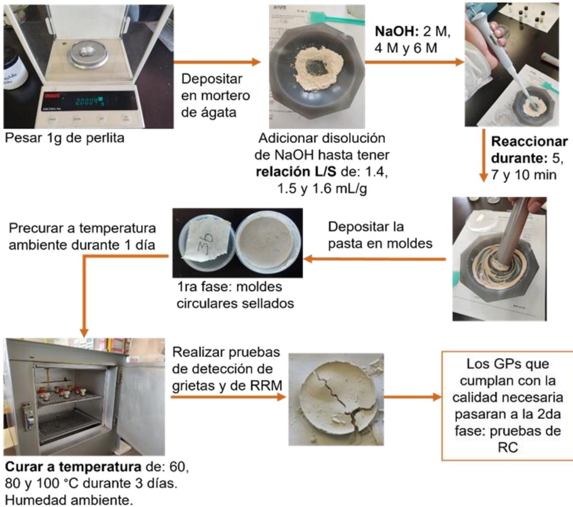
Figura 8. Procedimiento experimental para la síntesis de los GPs de PP
