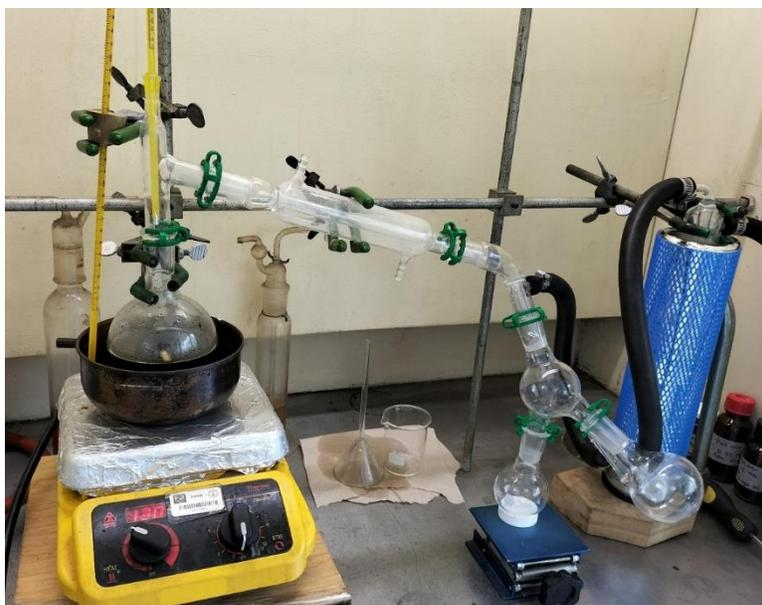
Figura 13. Montaje de material para destilación a presión reducida de ácido acrílico
