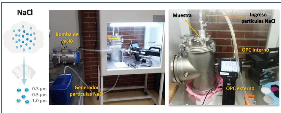
**Figura 23. Montaje experimental del equipo para filtrar partículas de NaCl y su cuantificación. Basado en la propuesta de Drewnick et al. 2021 (figura propia).**
