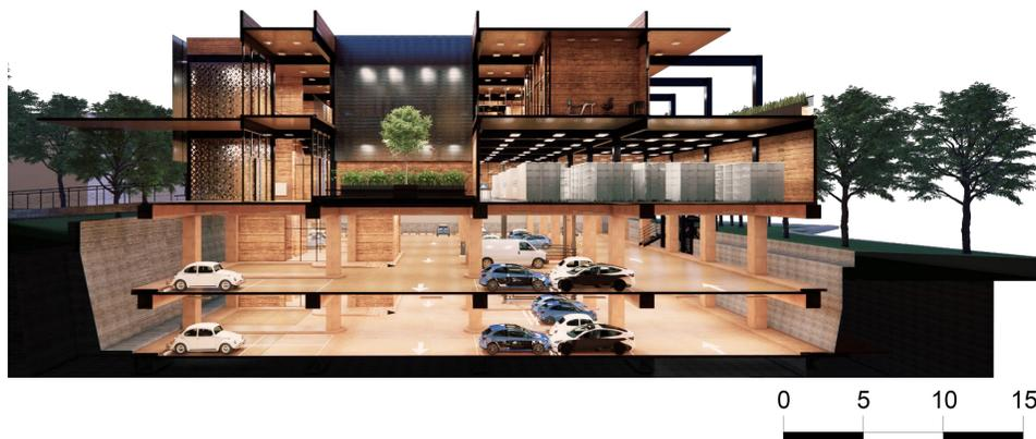
Gráfico 44: Sección transversal, propuesta de edificio, se observan los cuatro niveles. Elaboración propia conforme a la propuesta, (2022).
