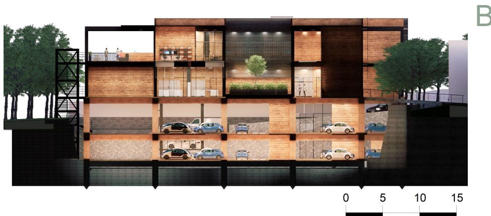
Gráfico 43: Sección transversal, propuesta de edificio, se observan los cuatro niveles. Elaboración propia conforme a la propuesta, (2022).
