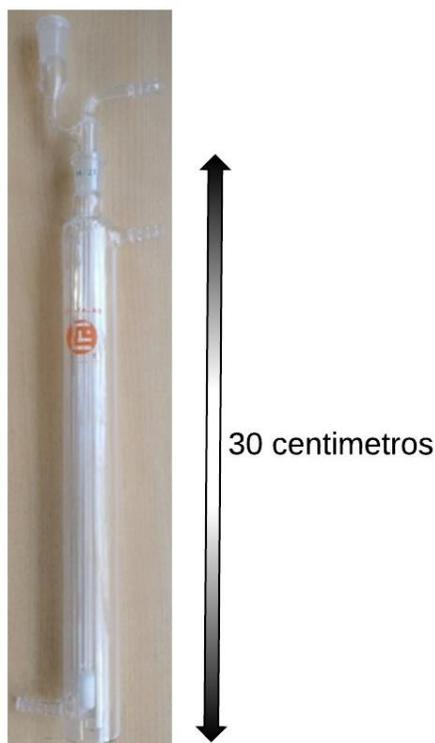
*Figura 6. Columna de espuma empleada para el control de espuma*
