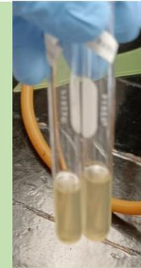
No hay producción de color tras adicionar los reactivos, se confirma adicionando Zinc, si hay color el Zinc redujo el nitrato no el microorganismo.
