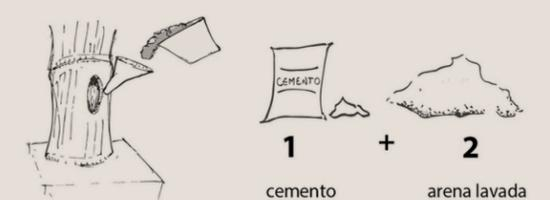
⑤ Procura que la mezcla entre en todo el nudo. Usa una varilla para vibrar el hormigón y asegurarte que baje la mezcla.
