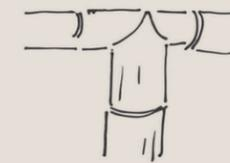
2 Coloca la caña sobre la columna, marca el punto donde va la varilla roscada.
