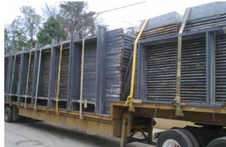
Ilustración 152.-Plataforma especial para cargar cimbra tipo Coppel.
