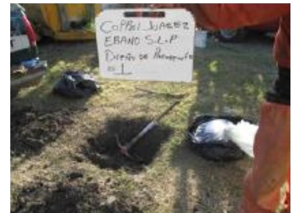
Ilustración 57.-Toma de muestra de material de terracería para diseño de pavimento, fotografía tomada en sitio en el año 2014.
