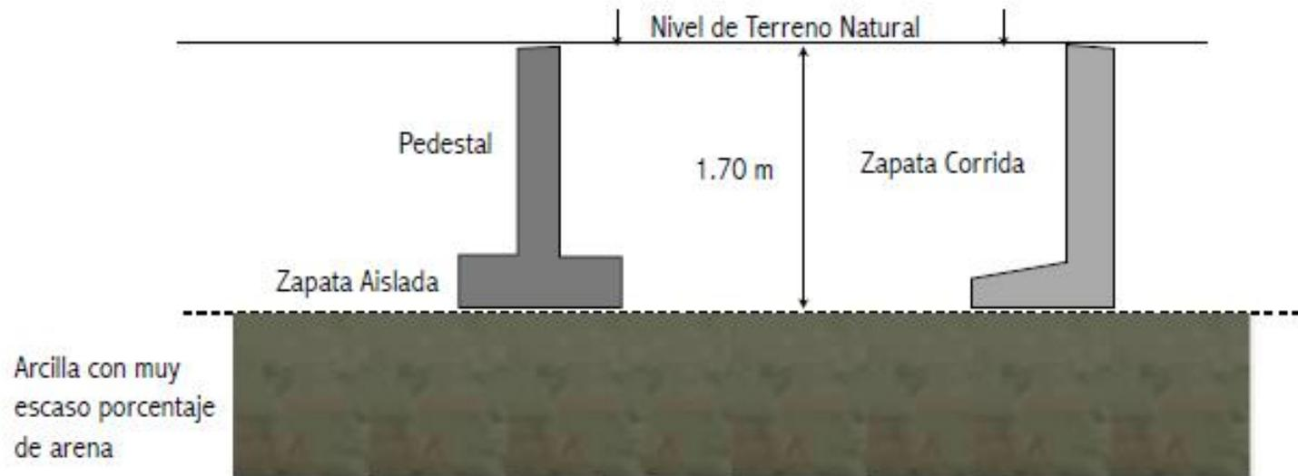
*Ilustración 44.-Representación gráfica de desplante de zapata corrida a 1.7m de profundidad, donde cambian las condiciones del material y la presión soportada por el suelo es mayor.*
