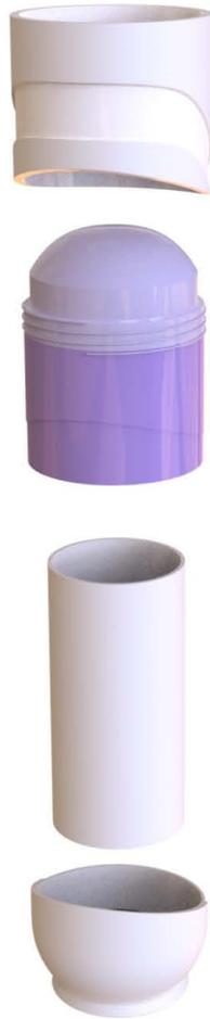
La carcasa y todos los componentes exteriores están hechos de inyección de ABS, cada una de las piezas se une por medio de un proceso llamada ultrasonido, el cual funde una pequeña parte de las piezas y las une. Así se logra armar el producto sin necesitar tornillos y conservando la ligereza que se requiere para su fácil manipulación.
