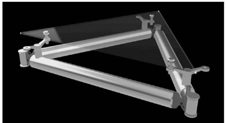
Figura 23: Isométrico de módulo de estructura portante con sistema de arañas de sujeción a placa plana de vidrio triangular. Propia. (2023)
