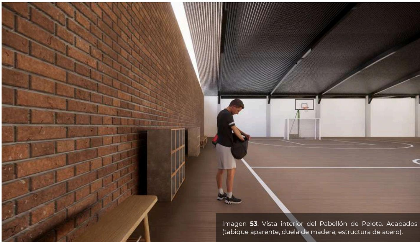
Imagen 53. Vista interior del Pabellón de Pelota. Acabados (tabique aparente, duela de madera, estructura de acero).
