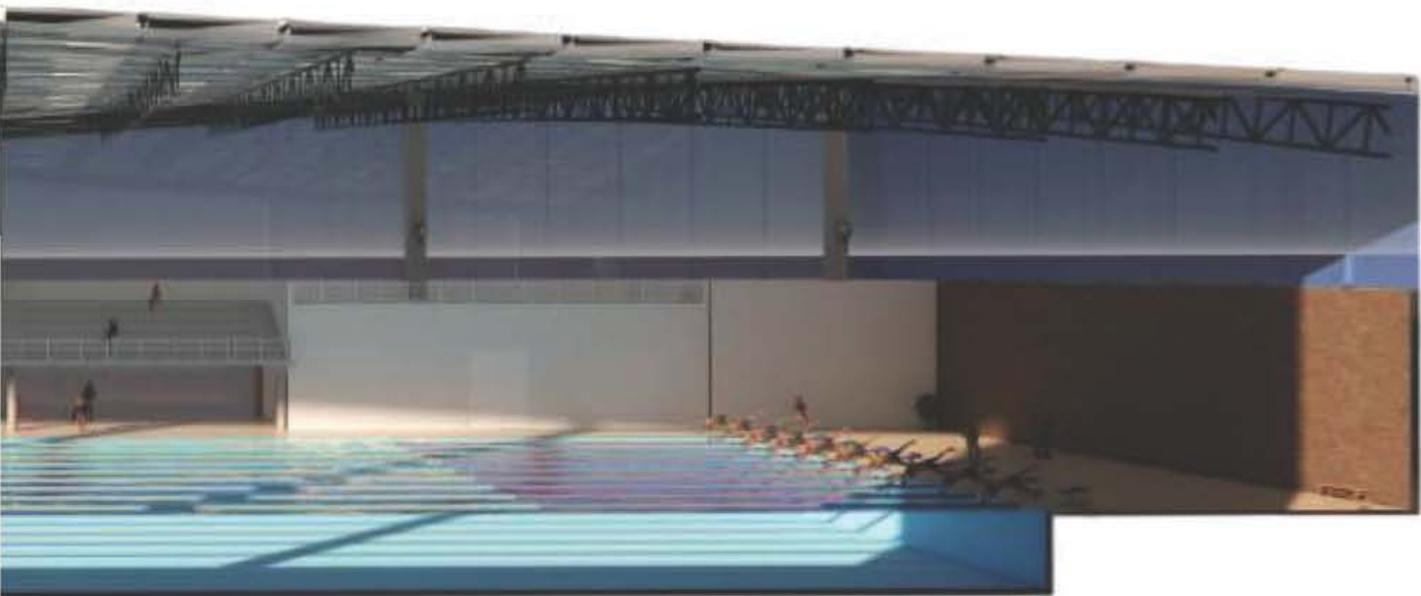
Imagen 35. Vista en corte longitudinal del Pabellón Acuático. Profundidad de albercas y estructura de cubierta.
