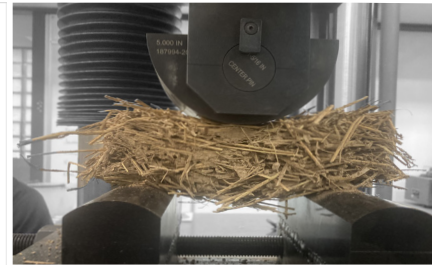
Fig 173 Prueba de tierra arenosa sin cribar. Se observa que conforme se genera la deflexión, la tierra se desprende de las fibras, dejándolas sueltas. Fotografía del autor.
