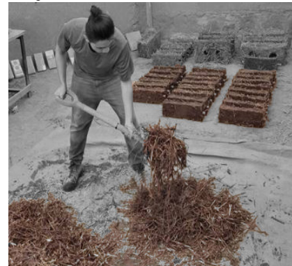
Fig 192 Revoltura de la pajarcilla para la mitad de las piezas. Fotografía del autor.
