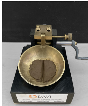
Pruebas para obtener límites en laboratorio: Fig 106 Materiales utilizados. Prueba de límite plástico. Copa de Casagrande para obtener límite líquido. Fotografías del autor.
