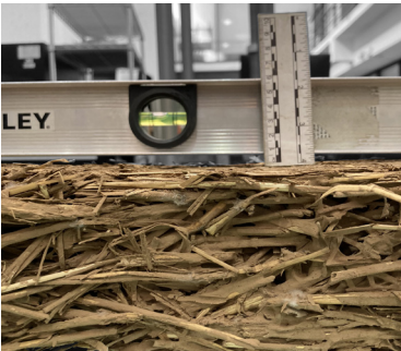
Fig 184 Deflexión permanente de solo 5mm en la pieza de tierra arcillosa tras la prueba. Fotografía del autor.
