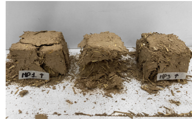
Fig 178 Probetas con 20% de pasta de cal y 15% de mucilago de nopal, después de la evaluación. Fotografía del autor.
