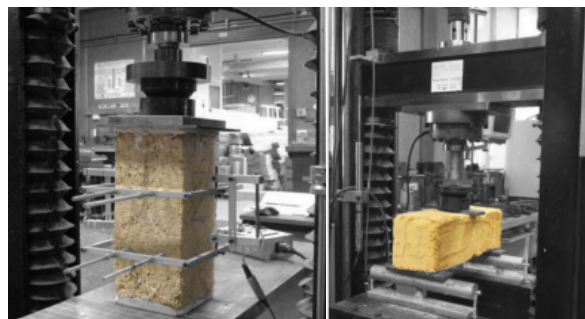
Fig 21 Pruebas a compresión y flexión de tierra aligerada. Tomado de Giarreton, Dizhur y Morriset, 2021.
