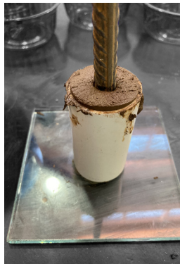
Fig 142 Prueba equivalente a la Copa de Casagrande. Fotografía del autor.
