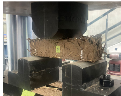
Fig 166 Deflexión de 5mm en la probeta. Fotografía del autor.
