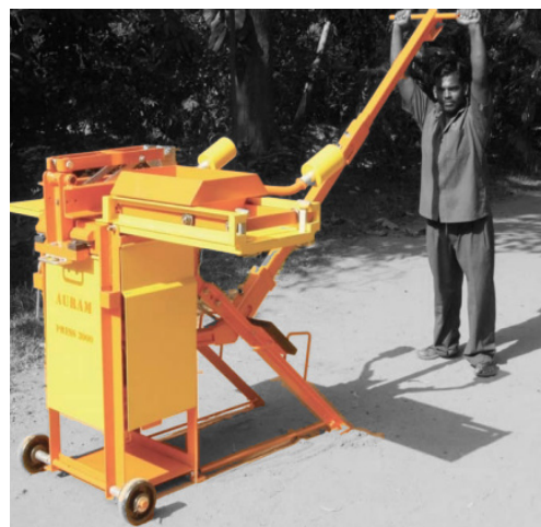
Fig 46 Prensa utilizada en Auroville Earth Institute para fabricar distintas piezas. Tomado de Comunal Taller, 2022.
