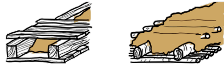
Fig 38 Diagrama de tierra como relleno con fibras. Autoría propia a partir de ONU Hábitat 1992.
