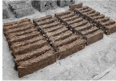
Fig 194 Almacenaje y secado de las piezas. Fotografía del autor.
