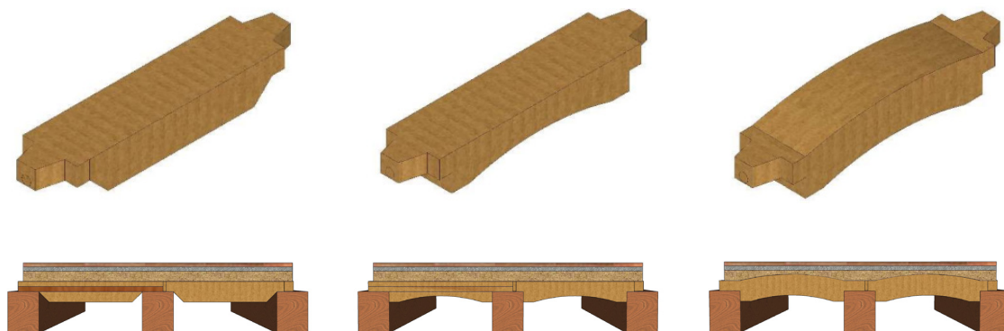
Fig 61 Inicialmente se proponen 3 diseños para las pieza prefabricada. Para esto se tomaron en consideración las limitantes por material, el análisis histórico, los criterios del entrepiso tradicional de pajarcilla y los casos análogos. Elaboración propia.
