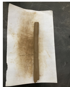
Fig 101 Bola-rollo-bola. Fotografía del autor.
