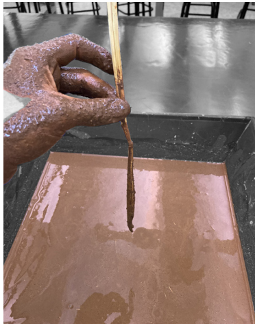
Fig 56 Prueba de viscosidad de la barbotina. Fotografía del autor.
