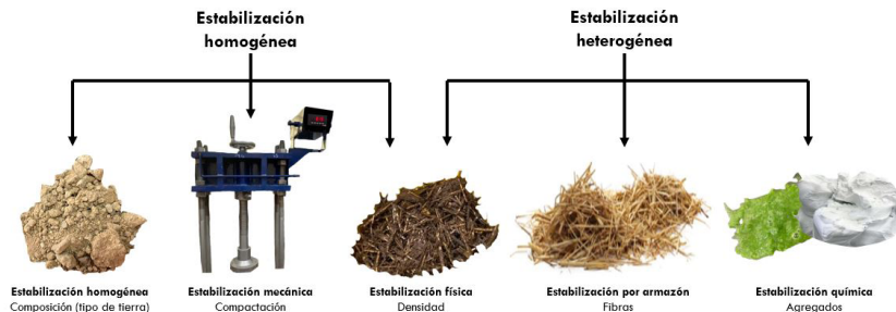
Fig 84 Diagrama de características buscadas a partir del tipo de estabilización. Elaboración propia.
