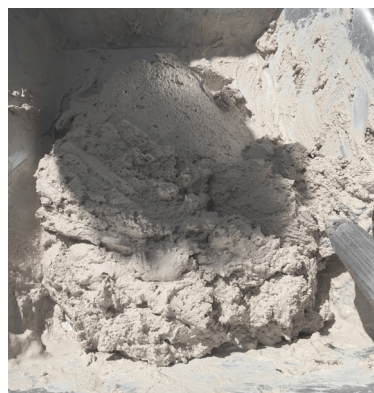
Fig 86 Revoltura de la pasta de cal, tratando de omitir el agua superficial. Fotografía del autor.
