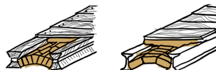
Fig 37 Diagrama de tierra como relleno en seco. Autoría propia a partir de ONU Hábitat 1992.
