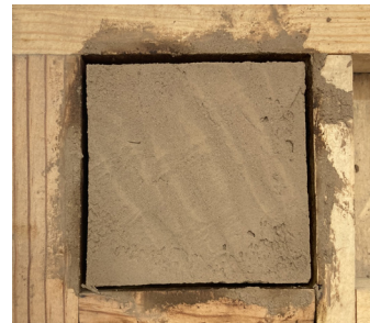
Fig 109 Prueba cuadrada de contracción. Fotografía del autor.
