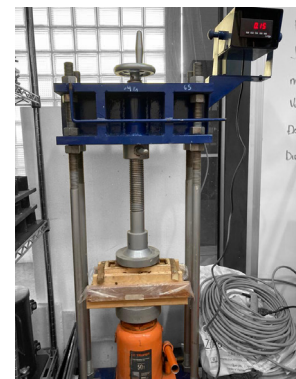
Fig 157 Compactación con prensa hidráulica. Fotografía del autor.
