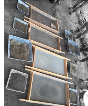
Fig 103 Tamizado en campo. Fotografía del autor.
