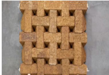
Fig 53 Preparación del sugarcrete para evaluación por peso. Tomado de Gutiérrez et al, 2022.
