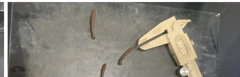
Fig 143 Prueba del límite plástico tras 2 rollos de 3mm. Fotografía del autor.
