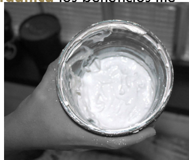
Fig 85 Pasta de cal utilizada en la experimentación. Fotografía del autor.
