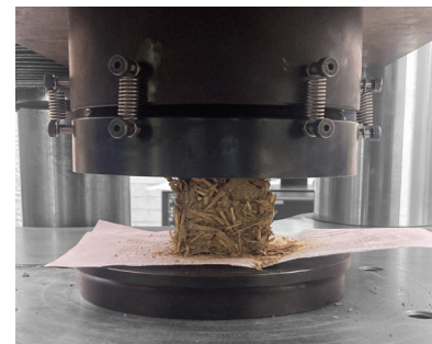
Fig 181 Prueba a compresión de tierra arenosa. Fotografía del autor.
