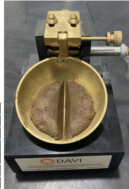
Fig 145 Copa de Casa-grande para límite líquido. Fotografía del autor.
