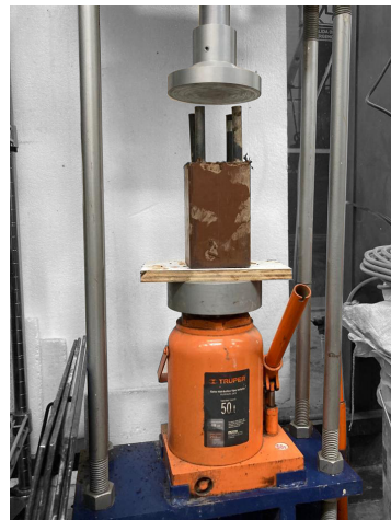
Fig 116 Compresión de las probetas en prensa hidráulica. Fotografía del autor.
