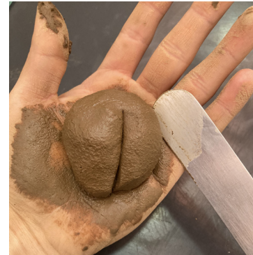
Fig 129 Prueba de corte de esfera donde se observa lo arcilloso de la tierra por la adherencia a la mano. Fotografía del autor.
