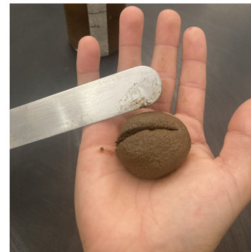
Fig 130 Prueba de corte de esfera donde la tierra no se queda pegada a la mano ni al hacer el corte. Fotografía del autor.
