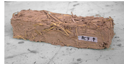
Fig 169 Probeta de pasta de cal donde se observa la ruptura en diagonal después de la prueba. Fotografía del autor.
