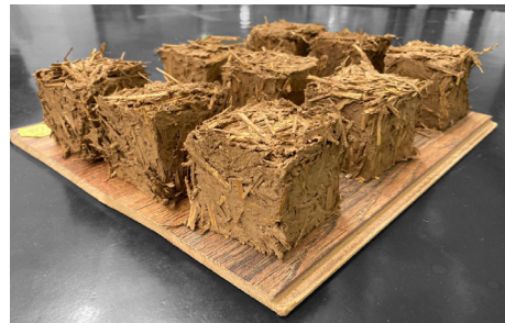
Fig 174 Piezas de evaluación a compresión por densidad. Fotografía del autor.
