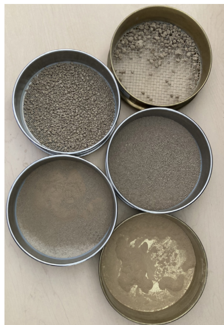
Fig 134 Material retenido por las mallas de la tamizadora después de la prueba de composición en laboratorio. Fotografía del autor.
