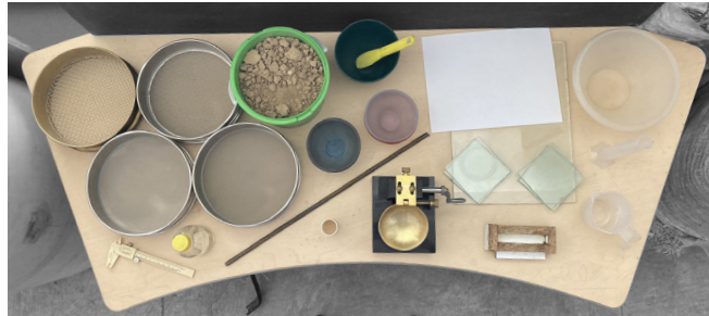
Fig 93 Equipos, herramientas e instrumentos utilizados en la caracterización de la tierra. Fotografía del autor.
