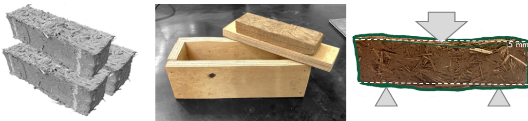
Fig 122 Cantidad mínima de probetas por evaluación, molde fabricado para las probetas a flexión y diagrama de prueba. Elaboración propia.
