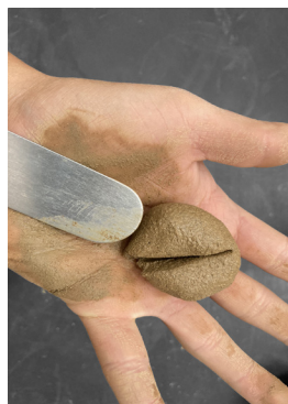
Fig 99 Prueba del corte de esfera. Fotografía del autor.
