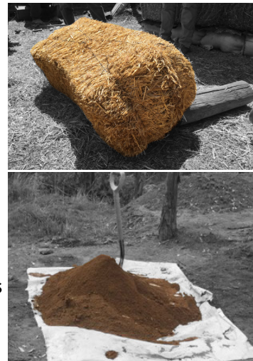
Fig 59 Componentes de la pajarcilla: paja de trigo previamente empacada y tierra arcillosa. Fotografías del autor.
