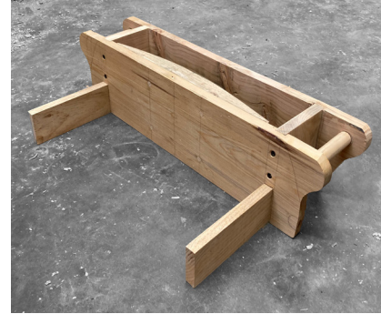
Fig 191 Molde modificado con apoyo del maestro carpintero Adrián Flores Hernández. Fotografía del autor.
