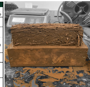
Fig 171 Elaboración de las probetas con tierra arcillosa. Fotografía del autor.
