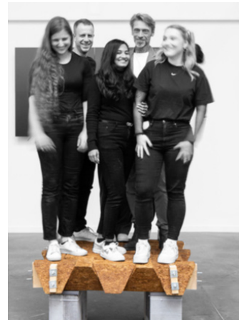
Fig 91 Evaluación empírica del sugarcrete. Tomado de Gutiérrez et al. 2022.
