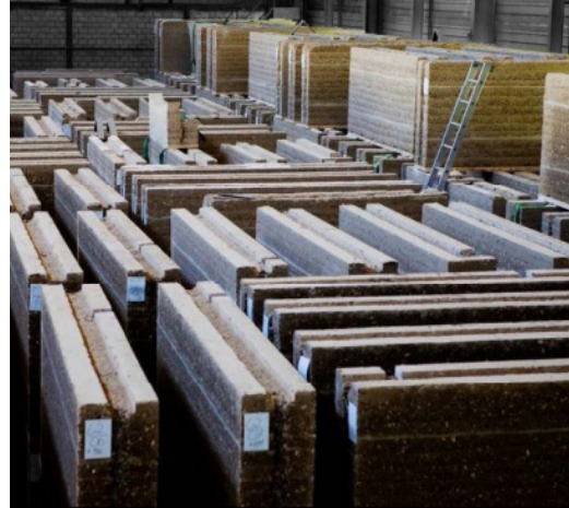
Fig 48 Almacenaje de tapiales prefabricados. Tomado de Cázares y Gustamante, s/f.
