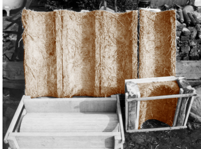
Fig 33 Molde de madera para piezas curvas. Tomado de Volhard, 2016.
