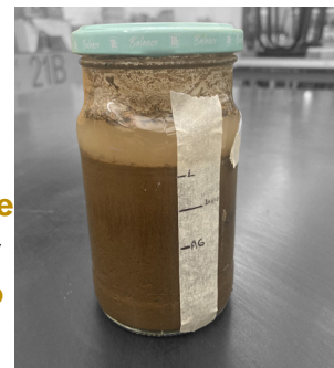
Fig 104 Sedimentación en laboratorio. Fotografía del autor.
