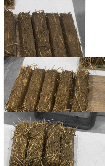
Fig 172 Secado de probetas. Arcillosas, limosas y arenosas. Inicialmente se hicieron 5 probetas arenosas, pero por la poca cohesión de la tierra solo se logró probar 3. Fotografía del autor.
