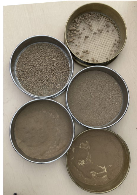
Fig 132 Mallas de tamizadora con las masas retenidas de la tierra de Tlaxco, Tlaxcala, posterior a la evaluación de tamizado en laboratorio. Fotografía del autor.
