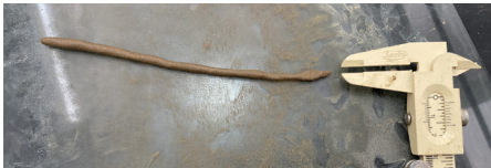
Fig 138 Prueba del límite plástico lograda. Fotografía del autor.
