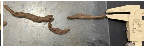
Fig 149 Prueba del límite plástico tras 3 rollos de 3mm por 10cm de longitud. Fotografía del autor.
