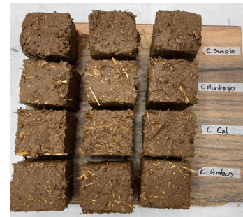
Fig 176 Secado de piezas para evaluación a compresión por estabilizante químico. Fotografía del autor.
