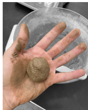
Fig 100 Prueba de sacudimiento. Fotografía del autor.
