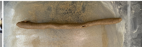
Fig 150 Prueba del límite plástico no lograda, llegando a 7mm de espesor. Fotografía del autor.
