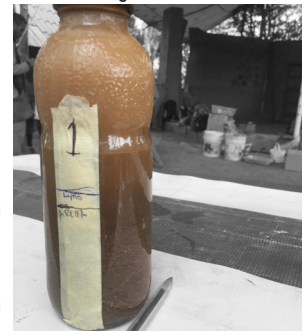
Fig 105 Sedimentación en campo. Fotografía del autor.
