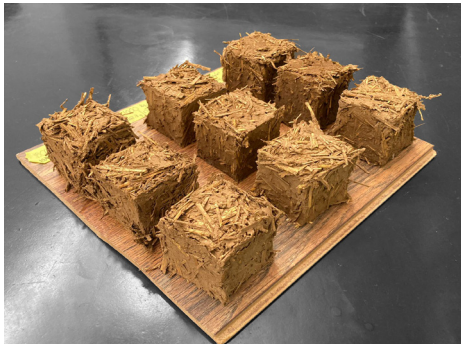
Fig 180 Secado de probetas a compresión con distintas tierras. Fotografía del autor.
