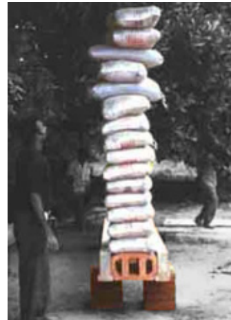
Fig 89 Prueba en campo del hourdi block 400. Tomado de Auroville Earth Institute, 2022.
