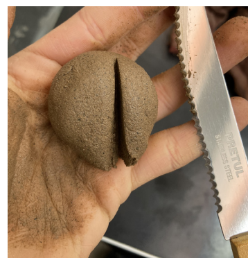
Fig 131 Prueba de corte de esfera. Aunque se ve una tierra arenosa, esta se queda pegada a la mano. Fotografía del autor.
