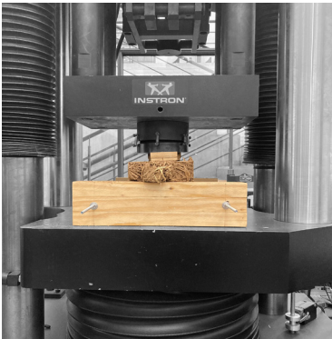
Fig 183 Colocación de pieza y soporte en para la prueba. Fotografía del autor.
