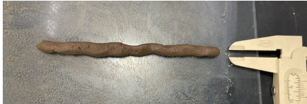
Fig 144 Prueba del límite plástico. Fotografía del autor.
