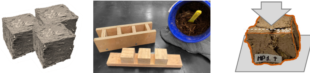
Fig 123 Cantidad mínima de probetas por evaluación, molde fabricado para las probetas a compresión y diagrama de prueba. Elaboración propia.
