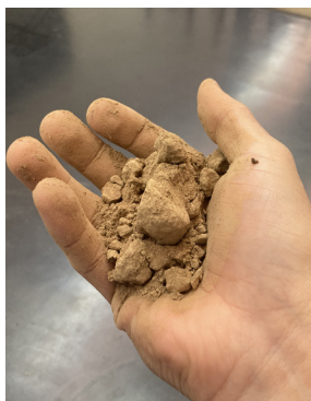
Fig 98 Consistencia en seco. Fotografía del autor
