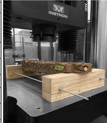
Fig 182 Colocación de pieza prefabricada y soporte en la máquina de ensayos universales para su evaluación. Fotografía del autor.
