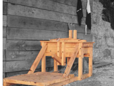
Fig 34 Prensa desmontable de madera para piezas de pajarcilla. Tomado de Pereyra Gigogne 2003.
