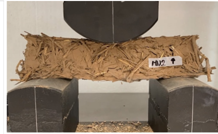
Fig 170 Prueba de la mezcla con mucilago de nopal. Se aprecia que tras los primeros 5mm de deflexión, la pieza se mantiene estable sin disgregar gran cantidad de materia. Fotografía del autor.
