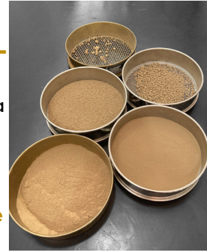
Fig 102 Tamizado en laboratorio. Fotografía del autor.
