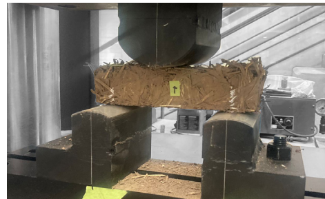
Fig 164 Inicio de prueba a flexión. Fotografía del autor.
