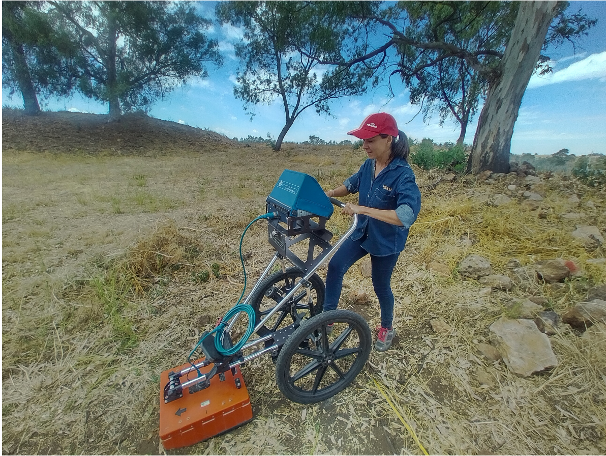
Figura 3.17: GPR GSSI, SIR 3000 con una antena de 270 Mhz
