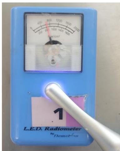
**Ilustración 6. Medición de la intensidad de la lámpara I-LED con la ayuda del radiómetro. Fuente propia.**
