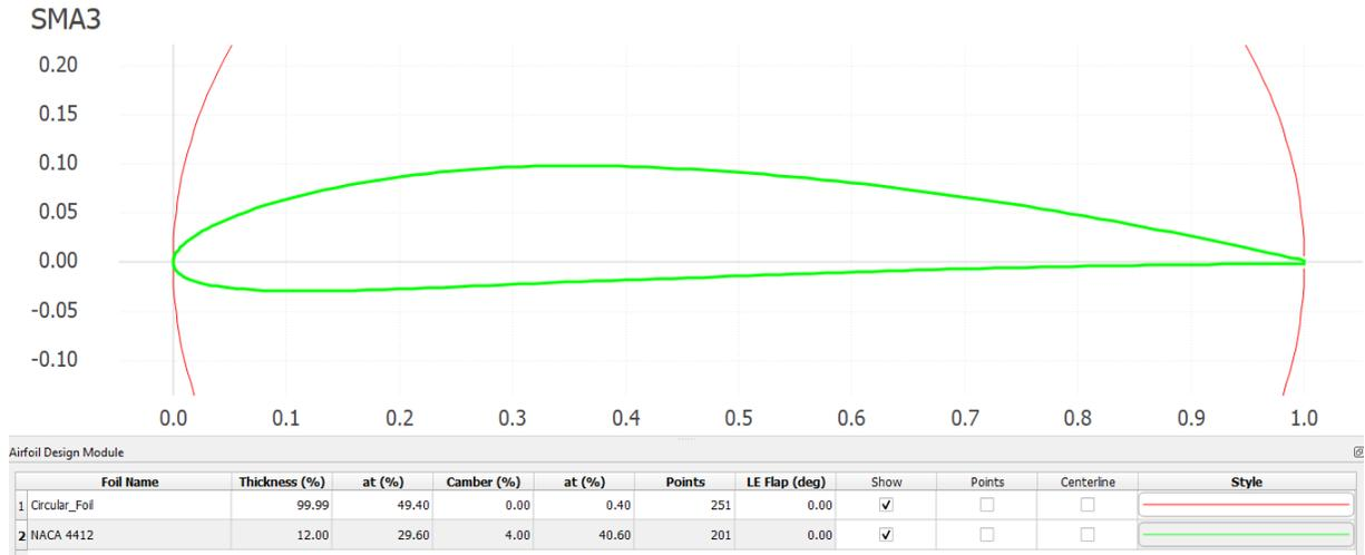
*Figura 5.9. Perfil NACA 4412 simulado en QBlade*
