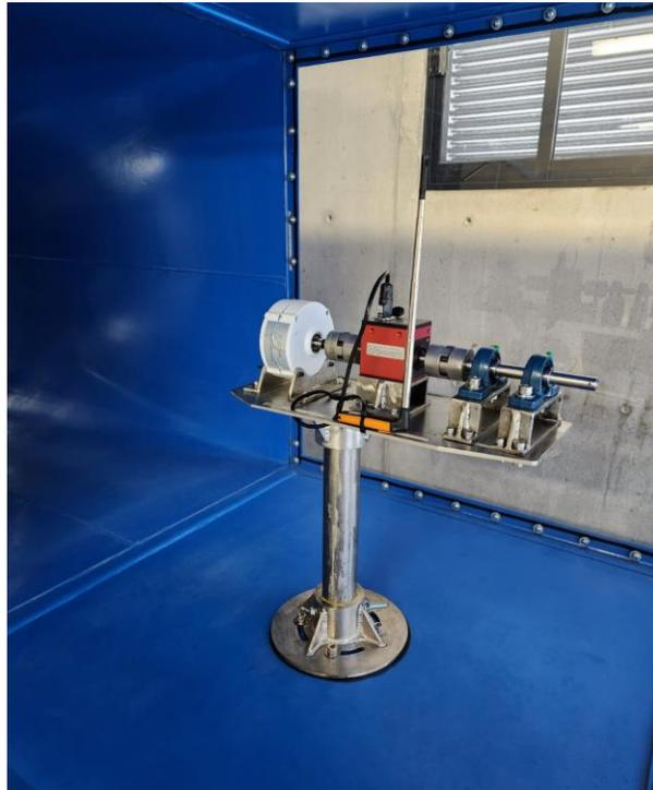
*Figura 5.12. Banco de pruebas instalado dentro de túnel de viento*
