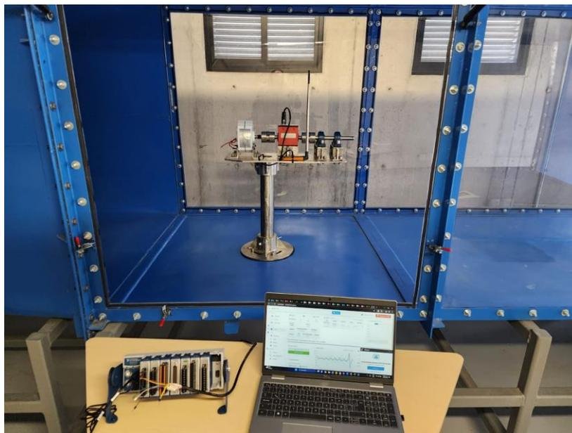
*Figura 5.13. Banco de pruebas dentro de túnel de viento, conectado a CompactDAQ de National Instruments*
