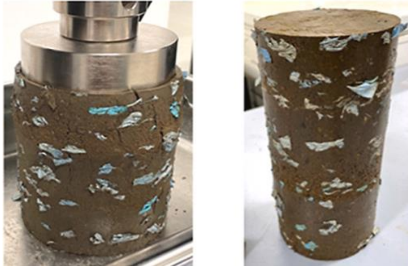
Figura 9. Guantes de nitrilo triturados y mezclados con subrasante de arcilla expansiva [42].
