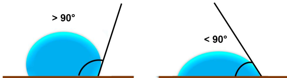
**Figura 22.** Ángulos de contacto para un material a) hidrofóbico y b) hidrofílico.
