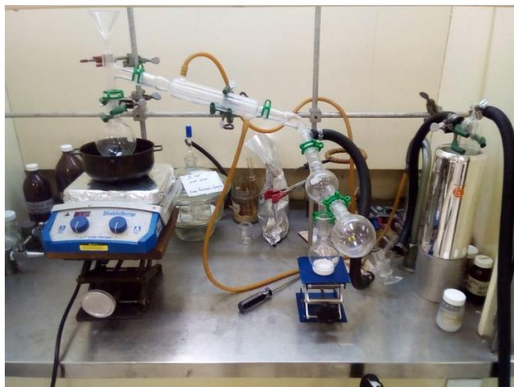
**Figura 23.** Sistema de destilación a presión reducida montado en el laboratorio.
