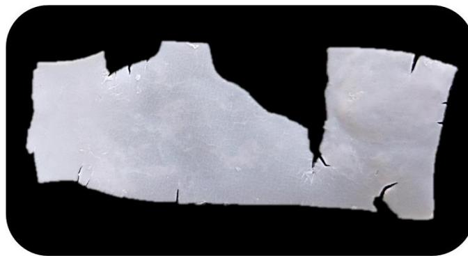
**Figura 24.** Deformación en matriz modificada con  $C_{GMA}$  40% v/v.
