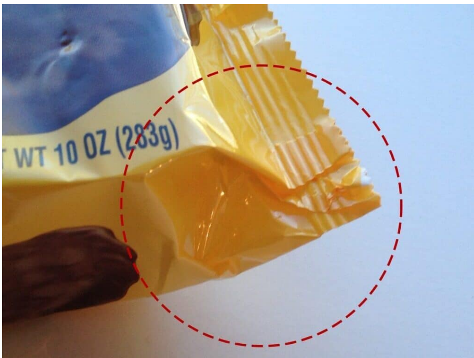
Figura 2.16: Plegues en el sellado: Se observa como el sellado se realiza sobre dos o más pliegues del material [24]
