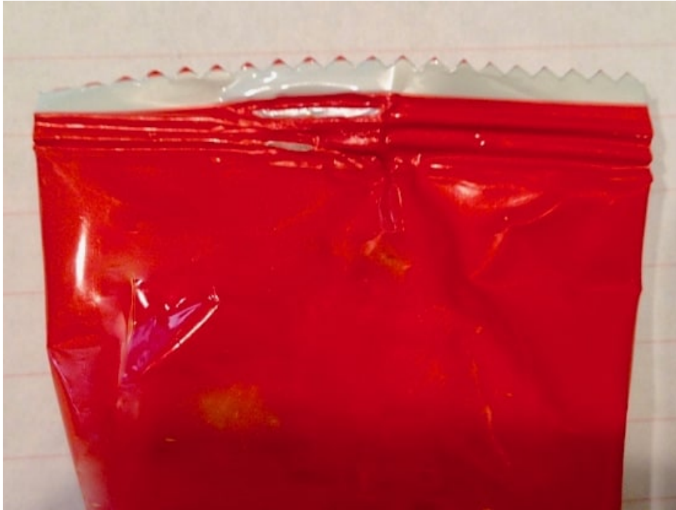
Figura 2.15: Desplazamiento de la película superior sobre inferior: En esta imagen se logra observar un desplazamiento en el momento del sellado, ya que la película inferior (color blanco) sobresale de la película superior (color rojo) [24]
