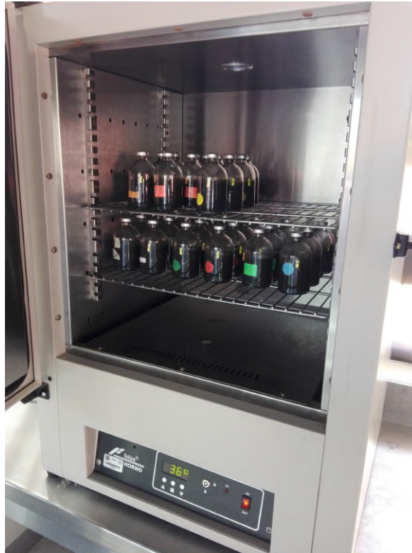
Figura 5.10: Fotografías de la colocación de los biodigestores en el horno
