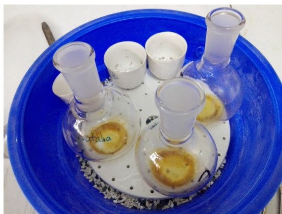
Figura A.4: Grasa final tras el procedimiento de extracción Soxhlet.
