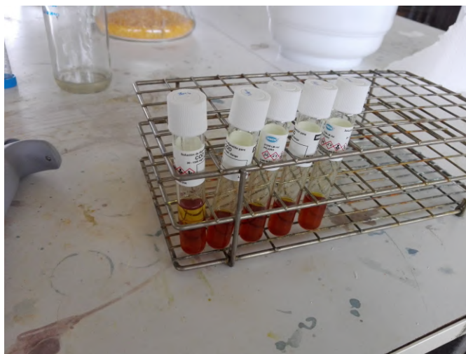
Figura 5.15: Tubos de ensayo de DQO enfriándose en una gradilla metálica.
