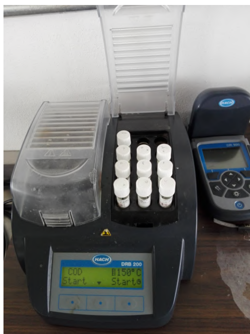
Figura 5.14: Fotografía del digestor de tubos para pruebas de DQO.
