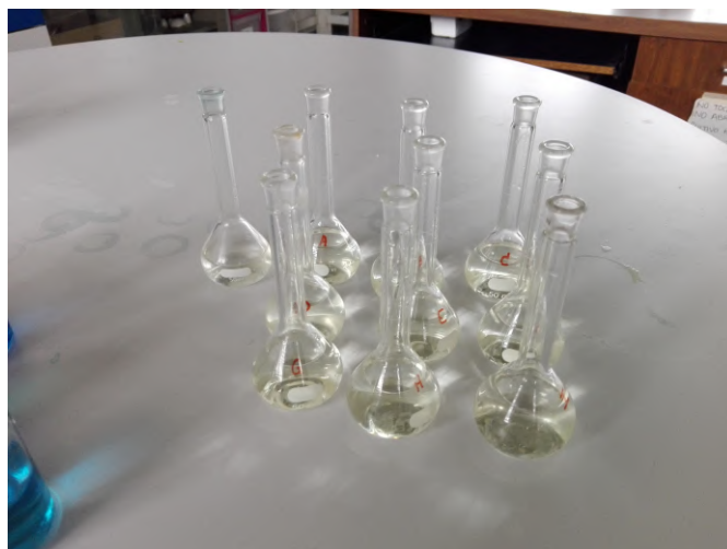
Figura 5.12: Muestras para la medición de fósforo listas para ser medidas en el espectrofotómetro.
