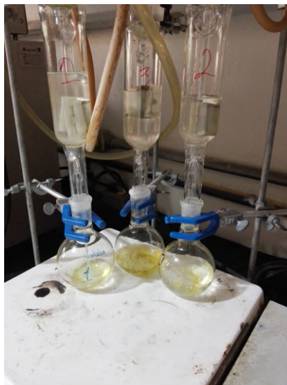
Figura A.2: Proceso de obtención de grasas en la tilapia a través del método de Soxleth.
