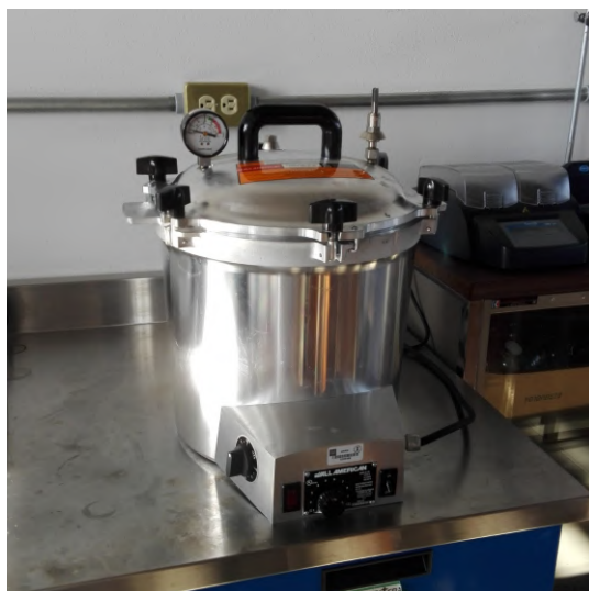
Figura 5.7: Fotografía de la autoclave del laboratorio de Bioenergía.
