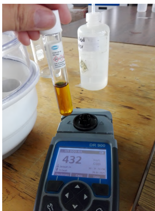
Figura 5.16: Tubo de DQO listo para la medición.
