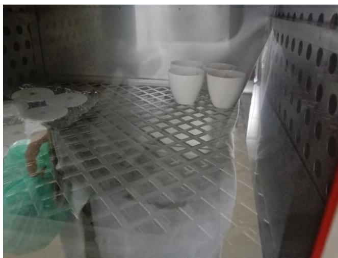
Figura 5.6: Crisoles en el horno a 105 °C.
