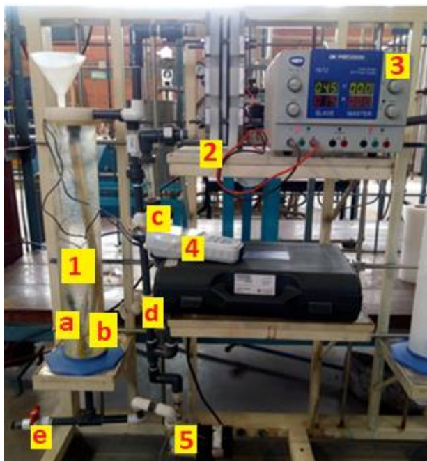
Figura 2.5.- Montaje del equipo para el proceso electroquímico: Contenedor de la solución problema (1), reactor FM01-LC (2), fuente de poder (3), medidor de propiedades fisicoquímicas (a: electrodo de pH y b: electrodo de conductividad), controles de flujo (c: válvula de alimentación al reactor; d: válvula de retorno del sistema; e: muestreo y drenaje) y bomba centrífuga (5).
