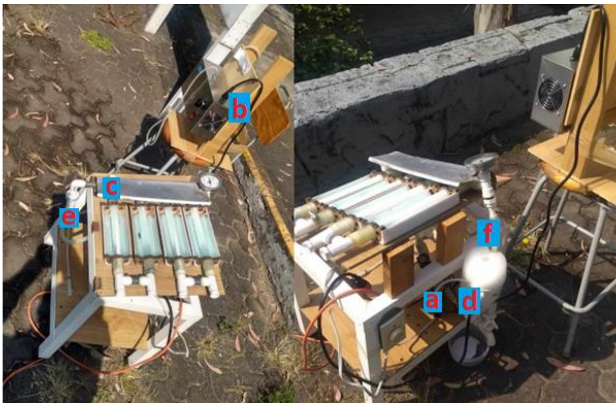
Figura 2.11.- Montaje de los equipos involucrados en el proceso fotoquímico: a) Bomba centrífuga, b) ozonificador Biozon, c) reactor fotoquímico de tipo CPC, d) tanque de PVC, e) alimentación del sistema, f) drenaje, salida para muestreo y retorno del sistema.
