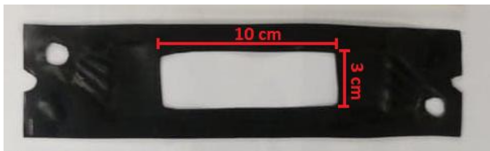
Figura 2.3.- Corte rectangular de 10 cm largo por 3 cm de ancho en el empaque para una superficie de contacto con el electrodo de 30 \text{ cm}^2 .
