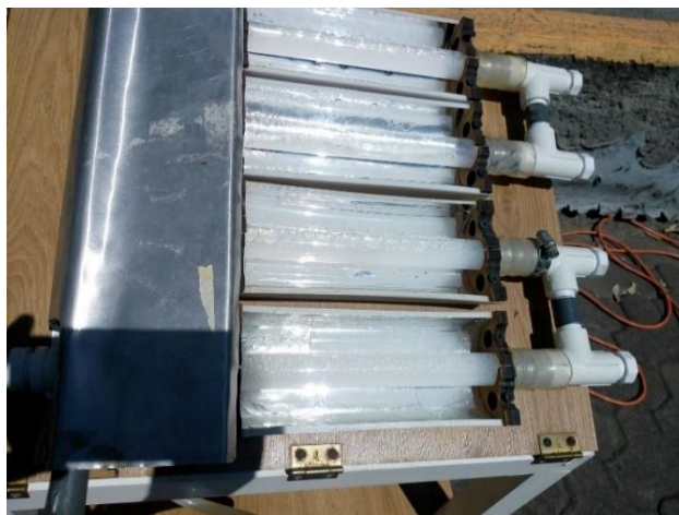
Figura 2.13.- Flujo del sistema (solución de paraquat, O_3 y TiO_2 ) a través del reactor fotocatalítico de tipo CPC.
