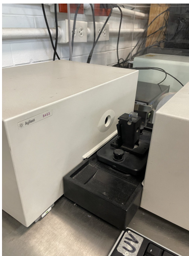
Figura 4.17: Espectrofotómetro del Instituto de Física UNAM.
