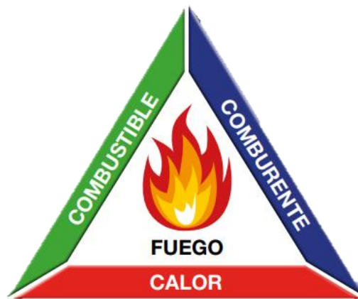
Figura 2: Triángulo del fuego. Se requieren de estos tres elementos simultáneamente para crear o mantener una combustión, por lo que la reducción o desaparición de uno de ellos provoca la extinción del fuego. Fuente: Academia Nacional de bomberos de Chile.
