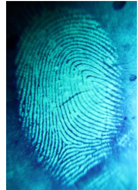
Ilustración 2. Huella revelada en lata de refresco con polvo magnético fluorescente. Fotografía tomada con luz UV por estudiantes de la Licenciatura en Ciencia Forense, UNAM (2019).
