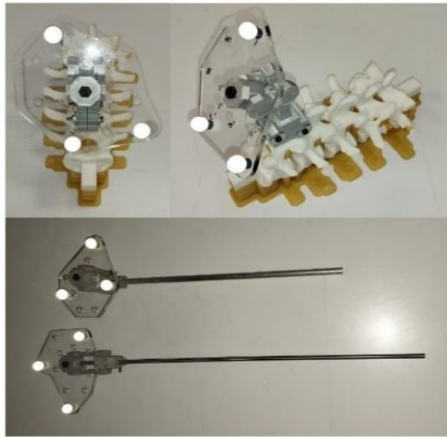
Figura 43 Marcos de referencia asociados a columna, efector final del robot y herramienta de punción reales
