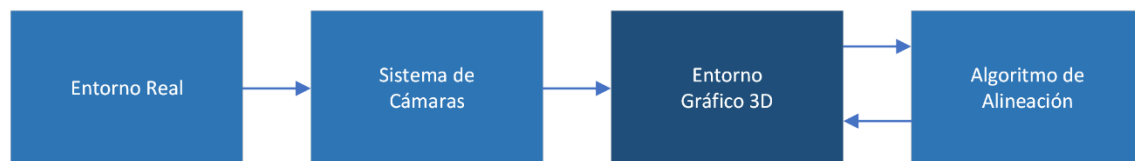
Figura 6 Diagrama de flujo de información del sistema de seguimiento
