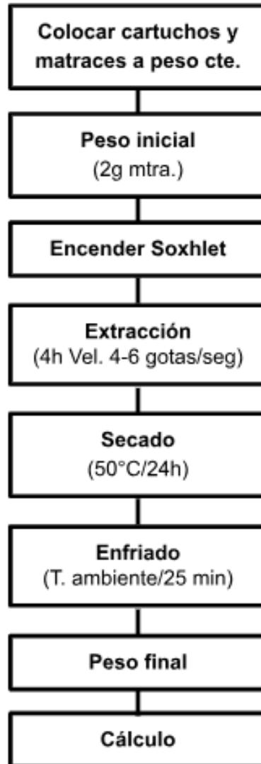
Figura 4. Diagrama de flujo para la determinación del porcentaje de extracto etéreo de una muestra.
