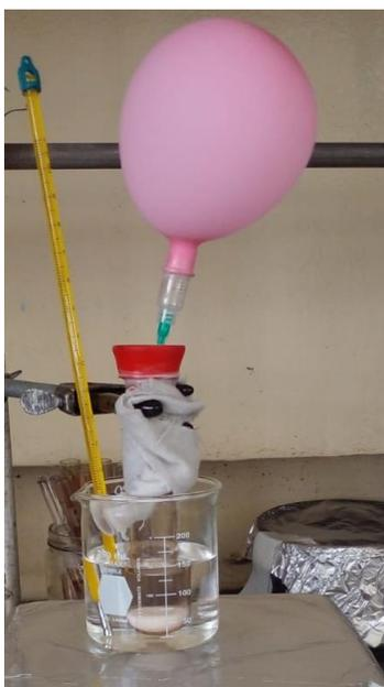
Figura 10. Reacción de funcionalización de las MSN con GPTMS.
