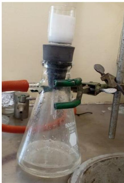
Figura 8. Filtración a vacío de las muestras.
