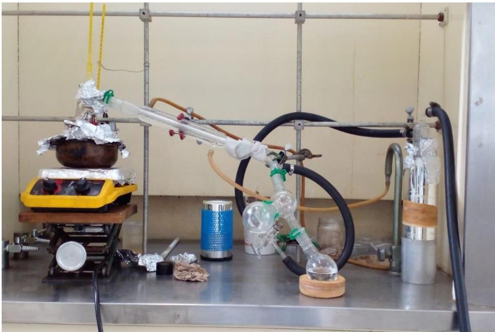
*Figura 9. Destilación a vacío.*
