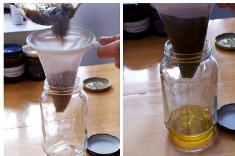
Figura 8. Extracción por maceración (Tomado de UNLP, 2020)
