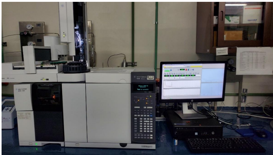
Figura 8. Cromatógrafo de gases 7890B con detector selectivo de masas 5977 de la marca Agilent Technologies empleado en la determinación de los contaminantes de las muestras
