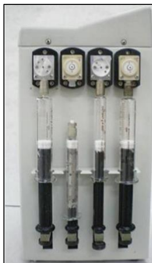
Figura 1.10. Vista frontal de una bureta MSFIA de Crison Instruments
