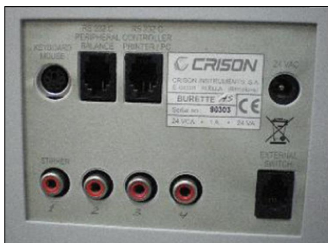
Figura 1.12. Conexiones traseras de una bureta multijeringa
