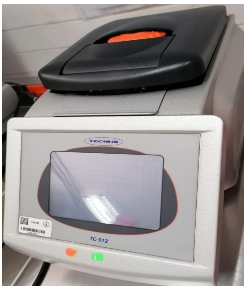
Figura 9. Termociclador Techne TC-512. Este equipo está diseñado para un control preciso de temperatura de las muestras, el rango de temperatura va de 4° C a 99° C. En la parte superior se colocan los tubos con la mezcla de reacción para llevar a cabo la PCR. Foto tomada en el laboratorio de Biología Molecular del Instituto de Química, UNAM. 24
