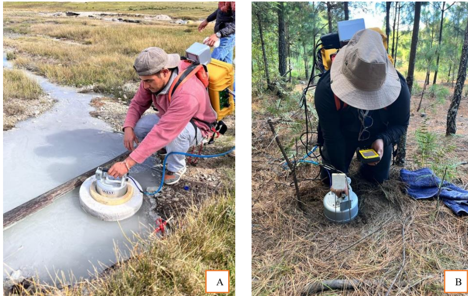
Figura 4. 4: Medición de flujo de gases en agua (a) y suelo (b).
