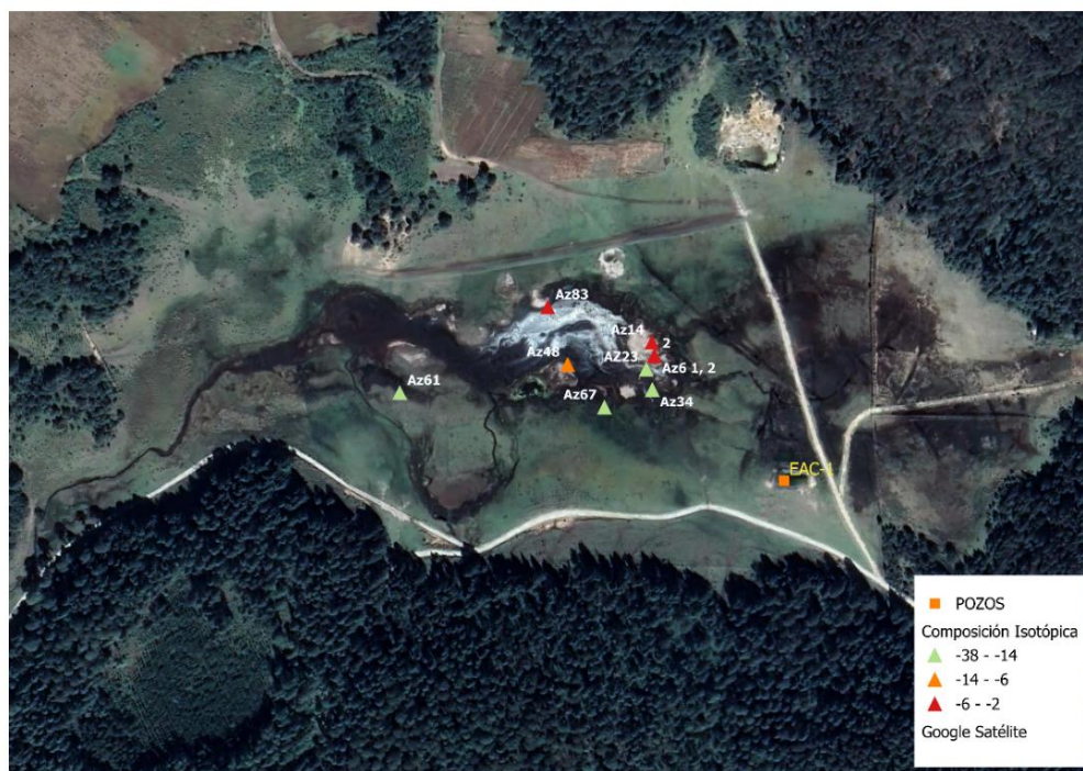
Figura 5. 16: Firmas de ^{13}\text{C} de flujos de \text{CO}_2 en la zona de los Azufres, 2015. Origen magmático (-2% a -6%), origen biogénico (-14% a -38% (Lewicki & Oldenburg, 2004; Cinza et al., 2010; Peiffer et al., 2018).
