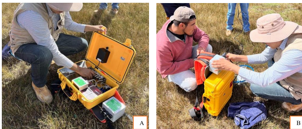
Figura 4. 3: Preparación y acondicionamiento del equipo en campo (a) Acoplamiento de la batería y revisión de general. (b) Conexión de sensores de temperatura y humedad.
