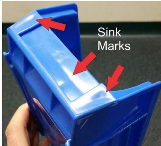
Figura 12. Pieza plástica con defecto de rechufe [66].
