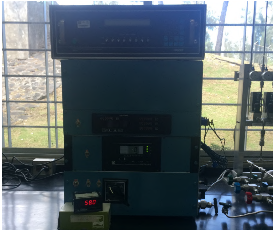
Figura 4.2. Medidor de presión, vacío y temperatura en la línea de vacío.
