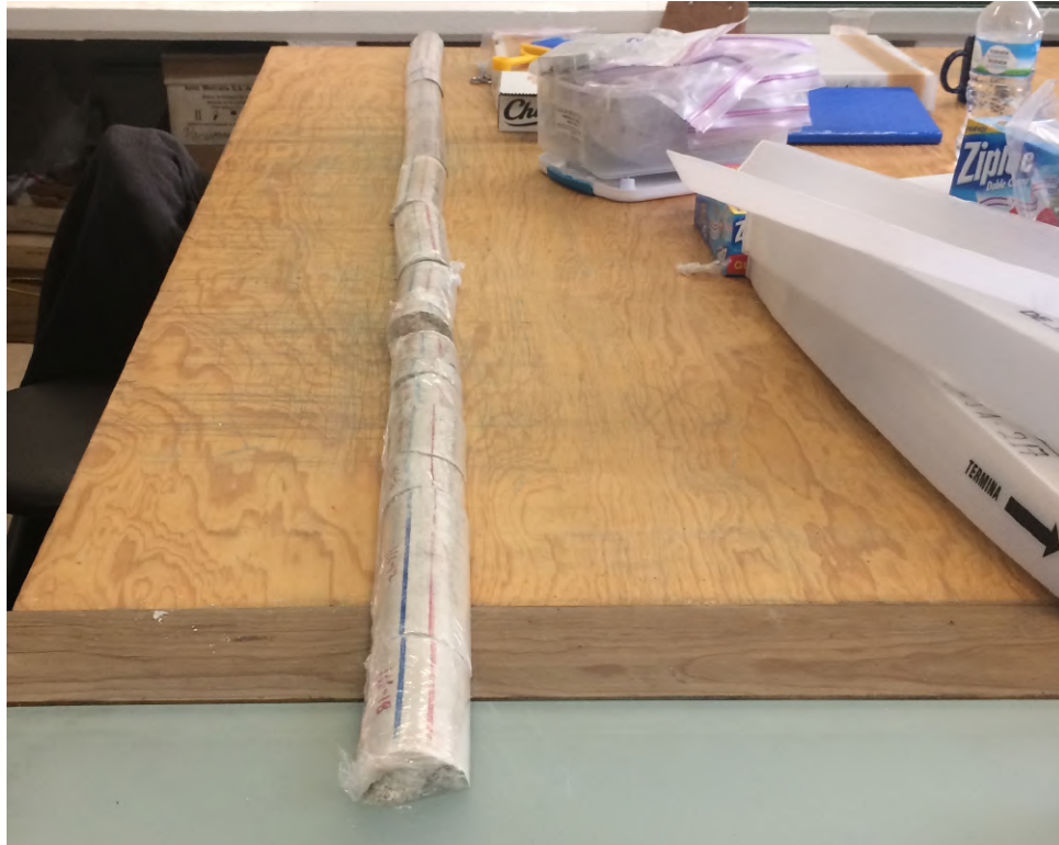
Figura 3.2. Núcleo de perforación previo a su corte para la obtención de las muestras.
