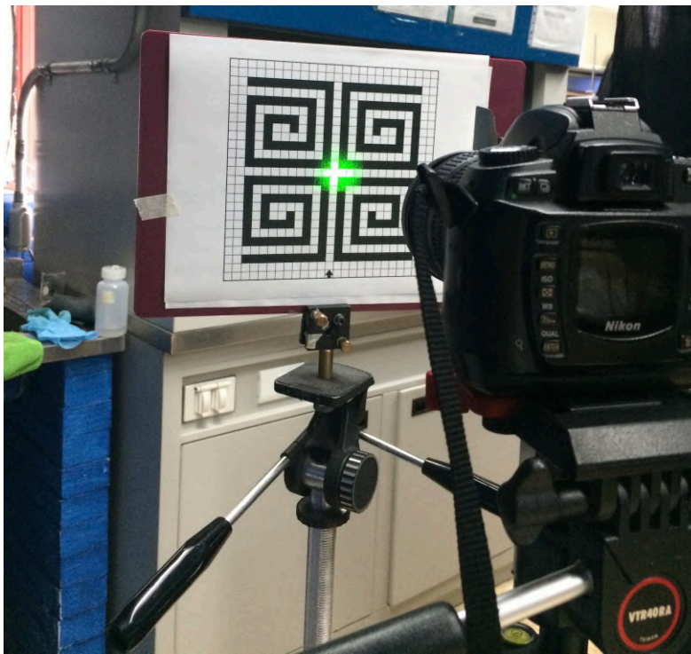
Figura 4.8. Medición de las imágenes generadas en la Shadowgrafía.
